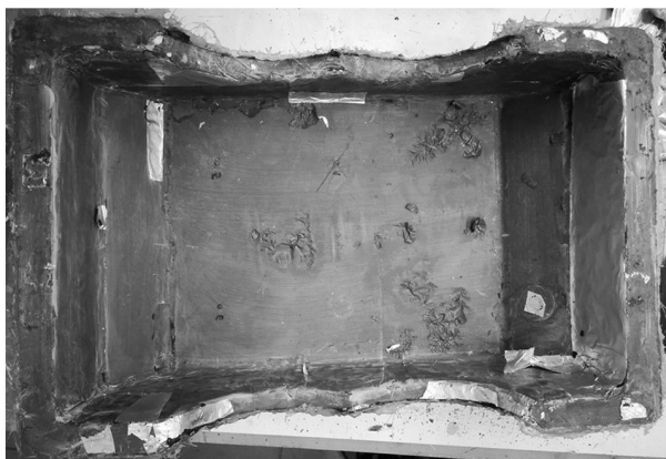
Fig. 2. Intermediate product mold - defects on gel coat surface Rys. 2. Półprodukt formy - uszkodzenia na powierzchni żelkotu
